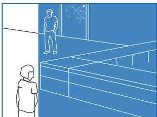
Das Ereignis wird durch jedes Objekt ausgelöst, das sich im Überwachungsbereich befindet. Das Objekt kann innerhalb des Überwachungsbereichs auftauchen oder von außerhalb in diesen eintreten.
