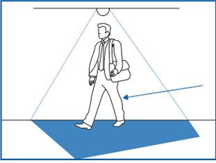
Dieses Ereignis wird ausgelöst, wenn die angegebene Anzahl von Objekten von außen in den Überwachungsbereich eingetreten ist.
