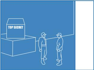
Dieses Ereignis wird ausgelöst, wenn die angegebene Anzahl von Objekten den zu überwachenden Bereich verlassen hat.
