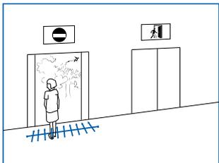
Dieses Ereignis wird ausgelöst, wenn die angegebene Anzahl von Objekten innerhalb des ausgewählten Zeitraums die für das Sichtfeld der Kamera konfigurierte Lichtschranke durchquert hat. Der Strahl kann uni- oder bidirektional sein.
