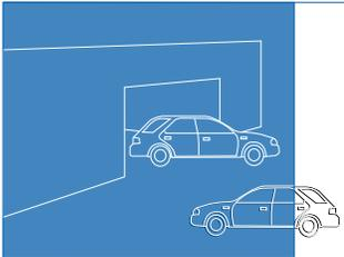
Dieses Ereignis wird ausgelöst, wenn sich ausgewählte Anzahl von Objekten im Überwachungsbereich befindet. Das Objekt kann innerhalb des Überwachungsbereichs auftauchen oder von außerhalb in diesen eintreten.
