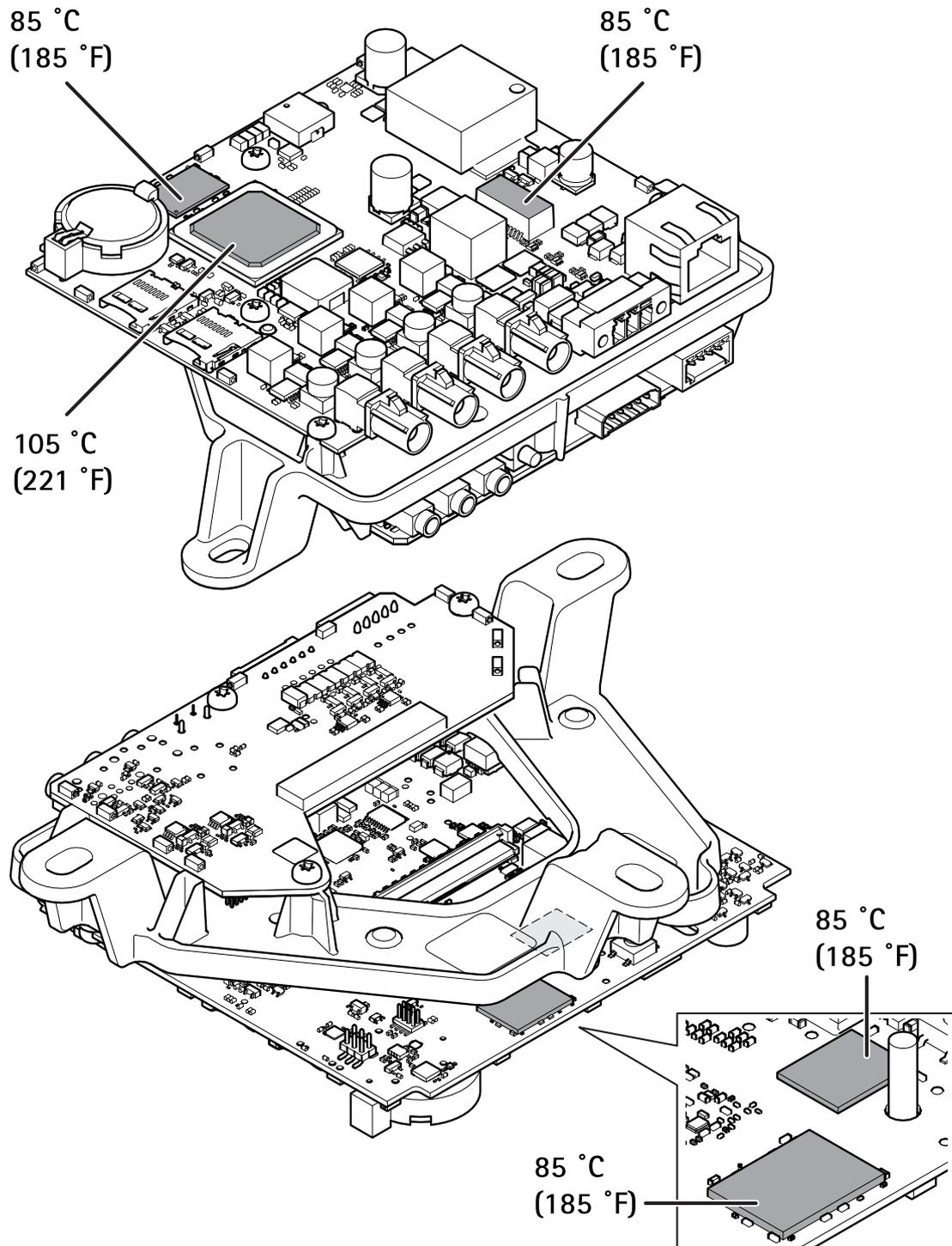
Maximal zulässige Temperaturen. Wenn die Umgebungstemperatur 35 °C oder höher beträgt, steigt die Temperatur der Komponenten und sie müssen gekühlt werden.
