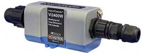
Der VI-COAX-2400W überträgt 10/100Mbps Ethernet und PoE/PoE+ mit Koaxial Kabel bis zu einer Distanz von max. 500m. Die Pass Through Technologie ermöglicht es, die PoE Speisung z.B. eines Midspans direkt über Koaxial Kabel weiterzugeben. Die Geräte brauchen keine Software-Konfiguration. Der VI-COAX-2400W ist in einem IP67 geschützten Gehäuse verbaut und so für die direkte Aussenmontage ohne zusätzlichen Anschlusskosten geeignet.
